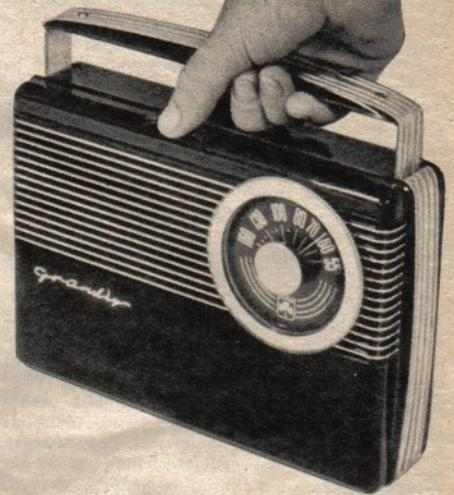
AM, 8 auf FM, 6 Röhren (ECH 42, 2×EF 41, EBC 41, EL 41) plus Netz Trockengleichrichter, zweifache FM-Zwischenfrequenzverstärkung und Ratio-Detektor als Abschluß des FM-Zweiges. Die Bandbreite im AM-ZF-Teil kann zweistufig geregelt werden, während die Tonblende dreistufig ausgeführt ist. Für den UKW-Empfang ist die bewährte „Netzantenne“ vorgesehen. Das Preßstoffgehäuse ist mit 53×33×22 cm relativ groß. Nicht vorhanden, um es nicht zu verschweigen, ist eine HF-Vorstufe auf UKW.
