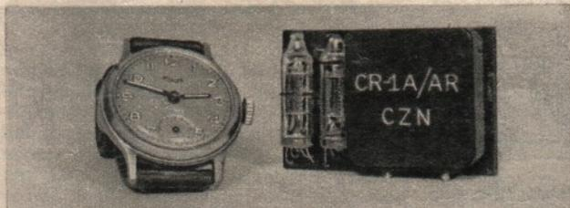
Abb. 5. Röhrenplatte mit Modulatorröhre (links), Oszillatortöhre (Mitte) u. Quarzkristall (rechts) im Größenvergleich zu einer kleinen Armbanduhr
